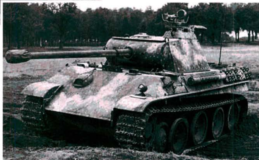
Le Panther est le premier char allemand à recevoir le système infrarouge FG 1250.
