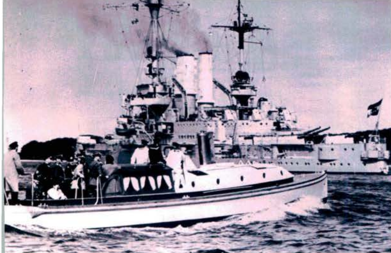
Le Schleswig-Holstein . On remarque les deux cheminées (au lieu de trois avant 1926-1928). Les quatorze canons de 170 sont remplacés par dix canons de 150.
